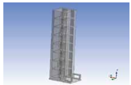
图2 数控龙门镗铣床立柱
